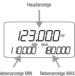
Während die Hauptanzeige unmittelbar nach dem Einschalten des Multimeters erscheint, müssen die beiden Nebenanzeigen durch Betätigen der Taste DATA/CLEAR aktiviert werden. Hierdurch wird vermieden, dass ein zu Beginn der Messung vorhandener (undefinierter) Zustand, z.B. ein Leerlauf, ständig als Maximalwert eingeblendet wird.
